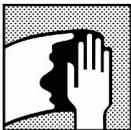
Limpeza de la superficie: remover cualquier contaminación de la superficie antes de aplicar el Primer Classic FAST, utilizando un desengrasante adecuado.
